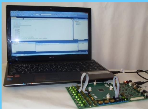
*Аппаратный комплекс для отладки программного обеспечения нейроколориметра*
