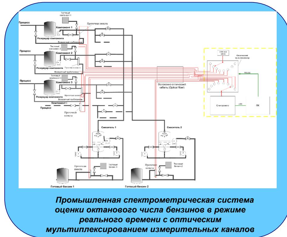
**Промышленная спектрометрическая система оценки октанового числа бензинов в режиме реального времени с оптическим мультиплексированием измерительных каналов**
